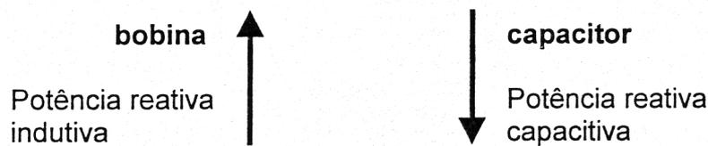
Devido a isto utiliza-se o capacitor para melhorar o fator de potência ( $\cos$ . Baixo) das instalações.
